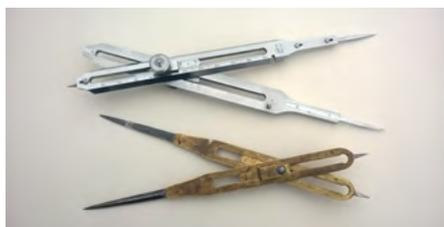
Abb. 1: Der Reduktionszirkel erleichtert durch das verschiebbare Gelenk den Umgang mit Linien, Flächen, Körpern, Kreisen, dem goldenen Schnitt und vermied Umrechnungen beim Massstabswechsel; oben ein Modell von 1964, unten eines von 1880.
