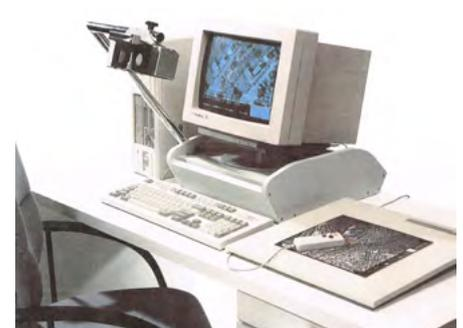
Abb. 6: PC basiertes digitales System DVP.
