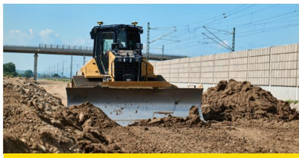
Lavorate in modo flessibile e controllate tutti i movimenti della lama con la configurazione del dozer in cabina, con il supporto di una soluzione di controllo macchina a doppio GNSS.
