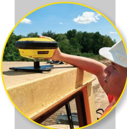
L'unità Leica iCON gps 120 si può avvitare nel supporto per antenna GNSS Leica AC02, ideale per tetti piani.
