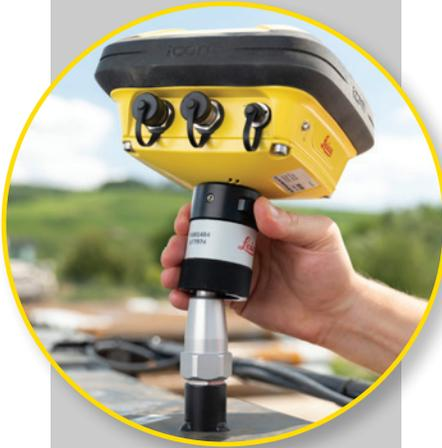
Una vez se han retirado los cables, la opción de liberación rápida le permite montar y desmontar la antena tan solo presionando un botón.
