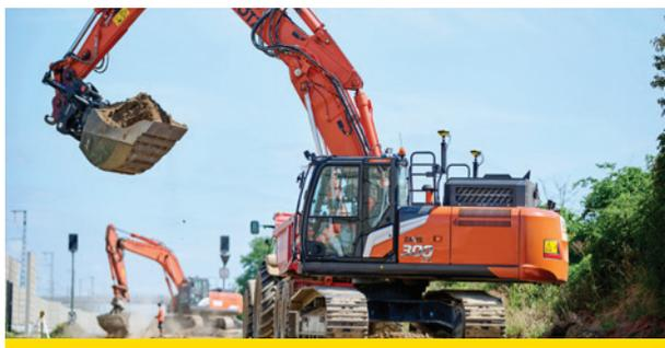
Para el movimiento de tierras y otras aplicaciones sumamente exigentes en las que la precisión de posición y de dirección es imprescindible, la iCON gps 120 ofrece una solución GNSS RTK doble (se precisa Leica CR50).
