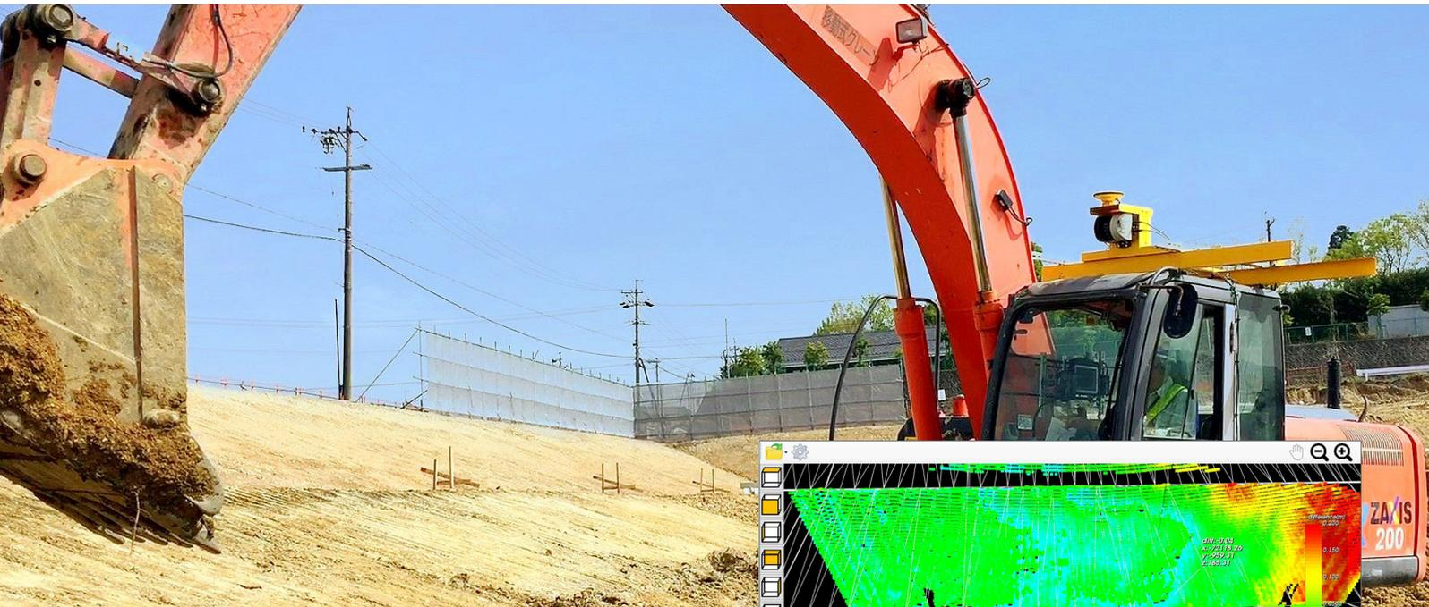
重機搭載レーザー計測システムは、施工後すぐにオペレータが操作するだけでリアルタイムな3次元出来形計測を実現します。出来形は見やすい点群のヒートマップで表示され、操作も容易です。施工の品質と生産性の向上に大きく貢献できるシステムです。
